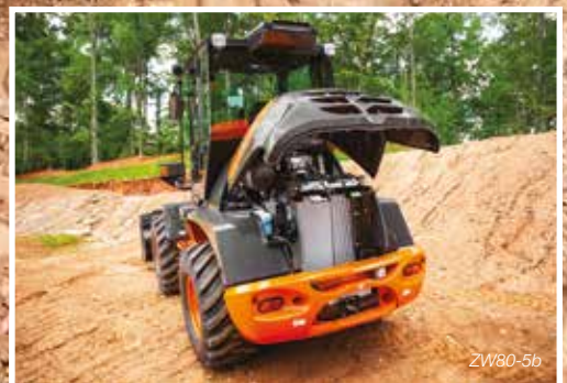
Accès facile pour l'entretien à partir du niveau du sol.
