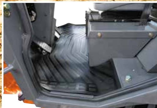
Le plancher plat de la cabine facilite le nettoyage.
